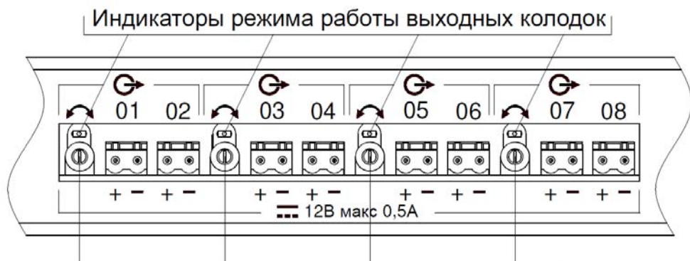
Рис. 2 Увеличенное изображение выходных колодок ПН.
