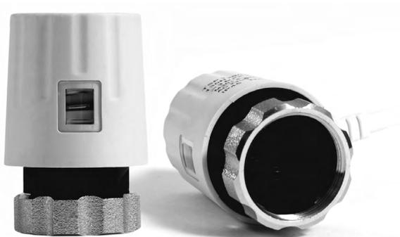
Термоэлектрический сервопривод нормально закрытый. Напряжение питания 220 В, 50 Гц. Тип нормально закрытый. Размеры для установки 30 x 1,5. Средний ход штока 3 мм.
