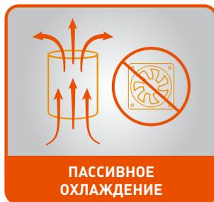
Запатентованная форма корпуса способствует естественному охлаждению конвекционного типа и делает работу стабилизатора абсолютно бесшумной.
