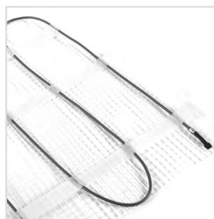
Электрический теплый пол на основе тонкого двужильного кабеля на стеклотетке. Удельная мощность 160 Вт/м<sup>2</sup>. Трубка для термодатчика с заглушкой в комплекте. Наличие двойного экрана для устранения электромагнитных излучений и защиты от поражения электрическим током. Высокопрочная и теплостойкая изоляция из сшиваемого полиэтилена. Оболочка из ПВХ пластика, которая не распространяет горения. Гарантия 16 лет.
