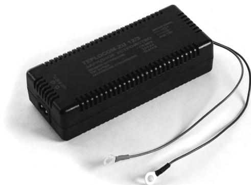
Дополнительное зарядное устройство для ИБП TEPLOCOM-300. Предназначен для ускорения зарядки свинцово-кислотных АКБ, подключаемых к TEPLOCOM-300. Зарядный ток — 3 А. Оптимальный заряд, защита от короткого замыкания и переплюсовки, защита от разряда АКБ.
