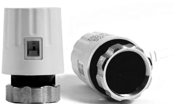
Термоэлектрический сервопривод нормально открытый. Напряжение питания 220 В, 50 Гц. Тип нормально открытый. Размеры для установки 30 x 1,5. Средний ход штока 3 мм.
