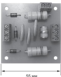
Блок защиты от скачков напряжения в цепях постоянного напряжения 24 В, 70 Вт.
