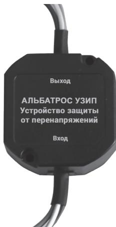
**220 В, 5 А. Устройство защиты от импульсных перенапряжений, УЗИП Класс III. Время срабатывания менее 25 нс. Максимальный импульсный разрядный ток (импульс 8/20 мкс), 6,5 кА, уровень напряжения защиты, 1,2 кВ. Уличное исполнение, IP65, рабочий температурный диапазон от -40 °C до +50 °C.**
