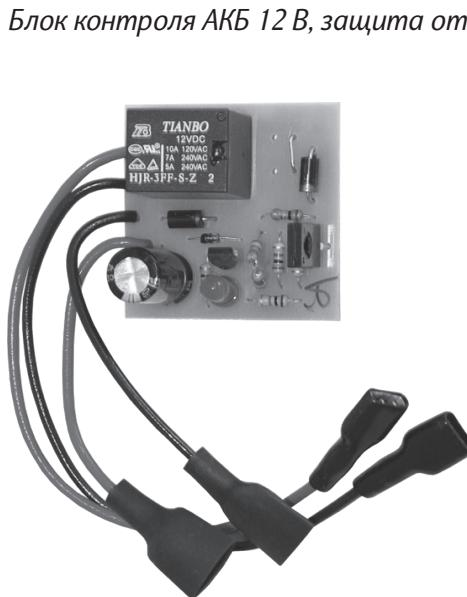
Блок БКА-12 предназначен для защиты аккумуляторной батареи (АКБ) от глубокого разряда и рассчитан на совместную работу с устройствами, использующими свинцово-кислотные АКБ номинальным напряжением 12 В. БКА-12 отключает нагрузку от АКБ при падении напряжения на клеммах АКБ до уровня 10–10,5 В. БКА-12 подключается между клеммами АКБ и аккумуляторными клеммами устройства. БКА-12 обеспечивает индикацию светодиодом факта подключения АКБ к нагрузке.
