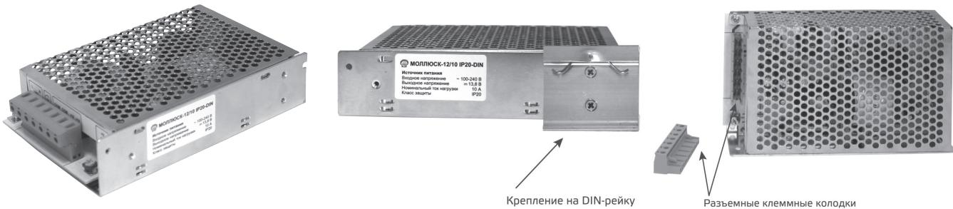
**12 В, 10 А.** Расширенный сетевой диапазон 100–240 В, габариты 160x99x37 мм. Перфорированный корпус IP20. Дополнительное крепление на DIN-рейку, защита выхода от КЗ и перегрузки. Быстроизъемные клеммы. Регулировка выходного напряжения.
