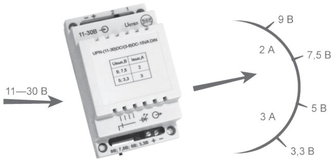
Преобразователь напряжения с входного 11–30 В в стабилизированное выходное напряжение, выбирается пользователем из ряда 9 | 7,5 | 5 | 3,3 В. Мощность нагрузки 15 ВА, электронная защита выхода от КЗ. Защита АКБ источника от глубокого разряда (11 или 22 В – выбирается пользователем). Пластиковый корпус под DIN рейку 35 мм.
