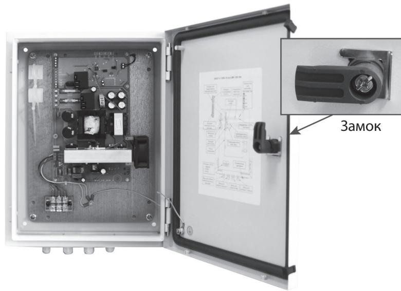
**24 В, 18 А, уличное исполнение, класс защиты IP65, металлический корпус, регулируемый ток заряда АКБ, термокомпенсация тока заряда АКБ. АКБ – внешние, 2 шт. от 17 до 250 Ач, 5 информационных выходов о состоянии источника. Электронная защита от перегрева, КЗ выхода и АКБ. Кнопка отключения нагрузки. Диапазон входного напряжения 170–250 В. Рабочий температурный диапазон от - 40°C до + 50°C. Мембранный кабельный ввод, замки на дверце.**
