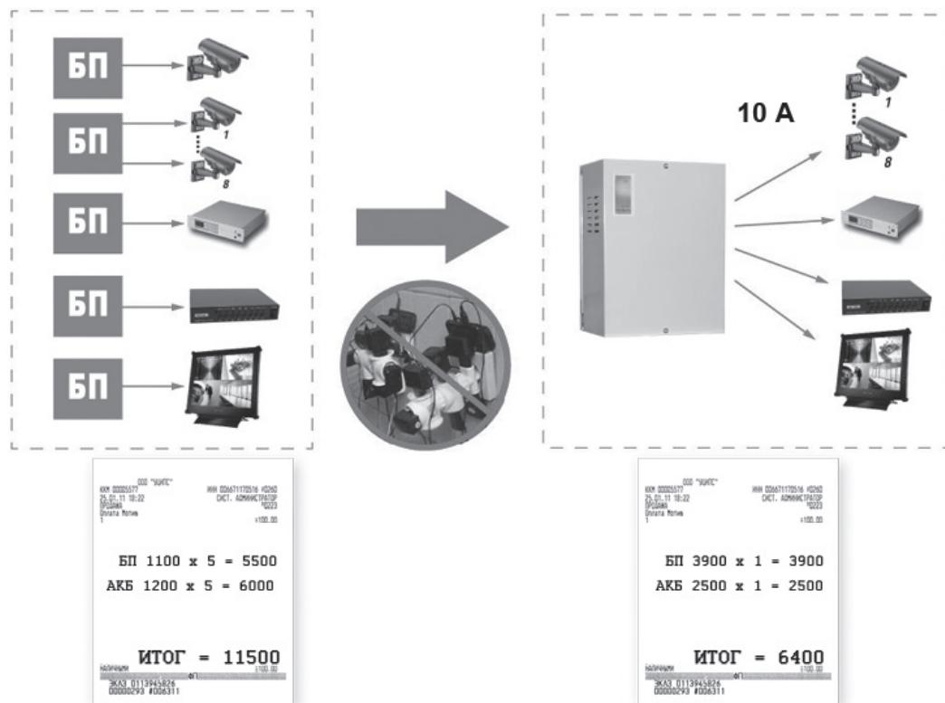
Источник предназначен для питания по восьми выходам видеокамер и других нагрузок с номинальным напряжением питания 12 В и номинальным током потребления по каждому выходу до 0,5 А при работе от сети переменного тока 220 В и в режиме резерва – от аккумуляторной батареи с номинальным напряжением 12 В. Источник имеет дополнительный выход 12 В 4 А для питания регистраторов и других устройств.
