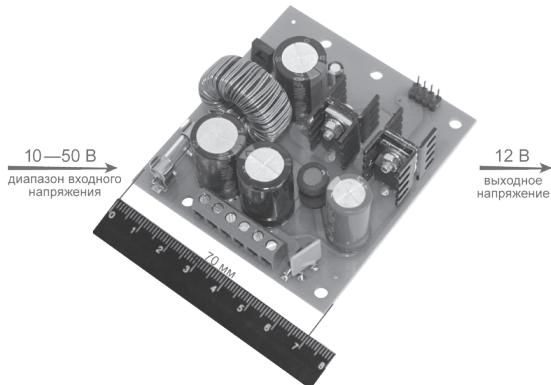
*Преобразователь напряжения с входного 10–50 В в стабилизированное выходное напряжение 12 В, 1,5 А. Диапазон регулировки выходного напряжения 12–15 В.*
