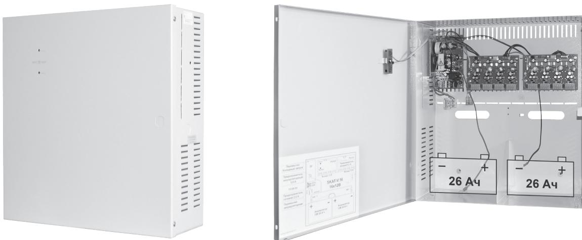
**16 выходов по 0,5 А или 8 выходов по 1 А, максимальный ток по всем выходам 6 А, необходима установка 2 АКБ 26 Ач. Независимая регулировка выходного напряжения по каналам, фильтрация помех по каждому каналу, защита от КЗ и перегрузки по каждому каналу.**
