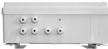
**Сетевой (не бесперебойный) источник питания.** Выходное переменное напряжение 24 В или 27 В, 50 Гц. 5 выходов, ток каждого выхода 1 А. Выход 27 В используется для компенсации падения напряжения на длинной линии. Защита выходов от КЗ PolySwitch, световая индикация по каждому каналу. Возможность объединения каналов до 5 А. Уличное исполнение, класс защиты IP56. Рабочий температурный диапазон от -40 °C до +50 °C.
