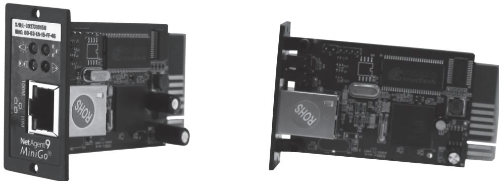
**SNMP-модуль для SKAT UPS-1000 RACK и SKAT UPS-3000 RACK.** Мониторинг и управление ИБП в компьютерной сети, с обеспечением автоматического корректного завершения работы серверов и рабочих станций. Автоопределение 10M/100M Fast Ethernet. Управление и конфигурация через Telnet, Web-браузер или NMS. Поддержка протоколов TCP/IP, UDP, SNMP, Telnet, SNTP, PPP, HTTP, SMTP.
