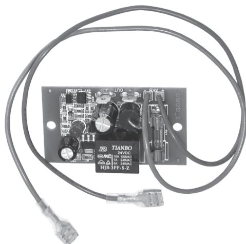
Блок БКА-24 предназначен для защиты аккумуляторной батареи (АКБ) от глубокого разряда и рассчитан на совместную работу с устройствами, использующими свинцово-кислотные АКБ номинальным напряжением 24 В. БКА-24 отключает нагрузку от АКБ при падении напряжения на клеммах АКБ до уровня 10–10,5 В. БКА-24 подключается между клеммами АКБ и аккумуляторными клеммами устройства. БКА-24 обеспечивает индикацию светодиодом факта подключения АКБ к нагрузке.
