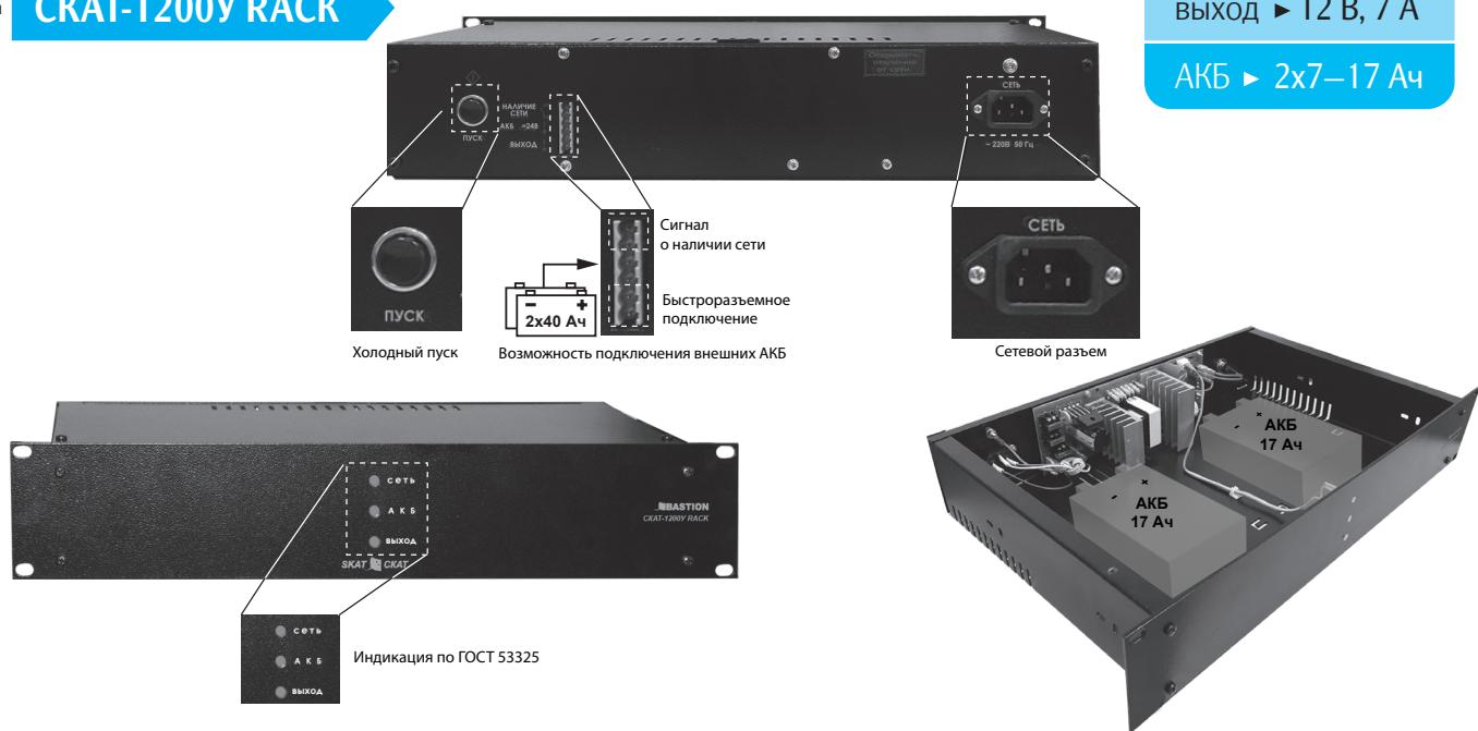
**12 В, 7 А**, диапазон входного напряжения **170–242 В**. Соответствует ФЗ 123 и ГОСТ Р 53325-2012: 3 индикатора «Сеть», «АКБ», «Выход» и 1 информационный выход в формате «сухие контакты реле» – «Наличие сети», защита выхода от перегрузки и КЗ, защита АКБ от глубокого разряда, КЗ и переполюсовки, контроль наличия АКБ, холодный пуск. Корпус под шкаф 19», высота 2U. Корпус под 2 АКБ 7–17 Ач (внутренние), возможность подключения 2-х внешних АКБ до 40 Ач.
