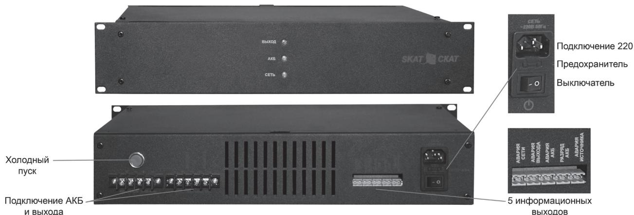
**48 В, 10 А.** Для построения систем питания удаленных объектов совместно с преобразователями напряжения. Ток заряда АКБ – 2, 4, 6 или 10 А, термокомпенсация заряда АКБ, контроль и защита АКБ от глубокого разряда, холодный пуск. Работает от 4-х внешних АКБ до 120 Ач. Защита выходов от перенапряжения, защита АКБ, 5 информационных релейных выходов о состоянии сети, АКБ, источника. Корпус для установки в 19" шкаф, высота 2U.
