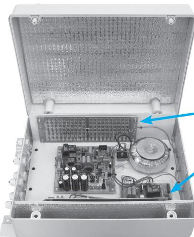
**12 В 4 А.** ИБП для эксплуатации в условиях крайнего севера. Рабочий температурный диапазон от -62 °C до +50 °C, встроенный подогрев АКБ, температурная компенсация заряда, ограничение тока заряда АКБ, задаваемое пользователем, электронная защита выходов от перегрузки по току и КЗ, релейные выходы «Переход на резерв» и «Разряд АКБ».
