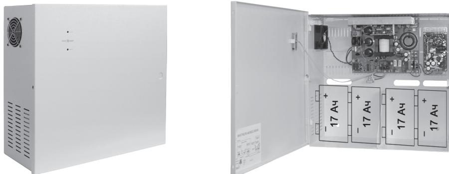
**48 В, 9 А.** Для построения систем питания удаленных объектов совместно с преобразователями напряжения. Максимальная мощность 500 ВА. Защита выходов от перенапряжения, защита АКБ, релейные выходы о состоянии сети и АКБ, АКБ – до 17 Ач (4 шт.)
