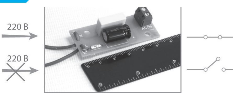
*Датчик наличия сети 220 В. Датчик представляет собой устройство для выдачи информационного сообщения о наличии напряжения в электрической сети в формате «СУХИЕ КОНТАКТЫ РЕЛЕ» и реализован в виде модуля с гибкими проводниками и выходной колодкой. Датчик обеспечивает гальваническую развязку выходных контактов.*
