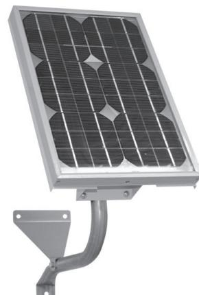
**12 В, 5,5 А.** Встроенная АКБ 7 Ач, автономный источник питания на солнечной энергии. Уличное исполнение, класс защиты IP56. Управление выходом от внешнего датчика движения или кнопки с регулируемой задержкой выключения. Режим работы день / ночь.
