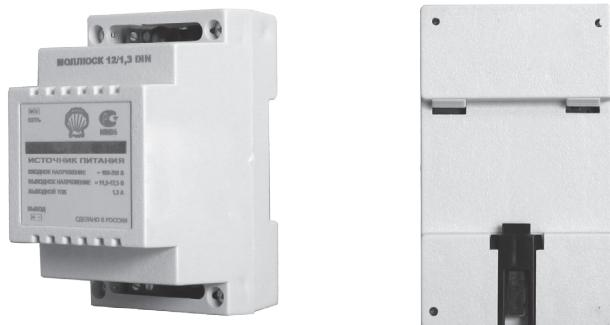
*Источник питания 12 В, 1,3 А. Расширенный сетевой диапазон 100–250 В. Корпус на DIN рейку, защита выхода от КЗ и перегрузки, прочность изоляции – 3 кВ.*
