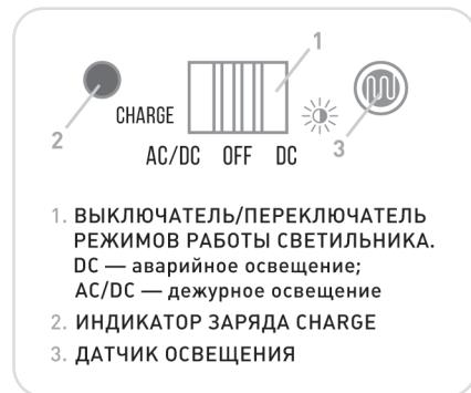
*Li-ion АКБ, 10 светодиодов, встроенный датчик освещенности, 2 режима работы (аварийный и дежурный). Вилка для питания 220 В.*
