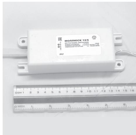
Источник питания 12 В, 5 А для скрытой установки в кабельные каналы, распаечные коробки, кожух видеокамеры, габариты 150 x 56 x 35 мм, защита выхода от КЗ и перегрузки, прочность изоляции 3 кВ, проушины для крепления, корпус IP67.
