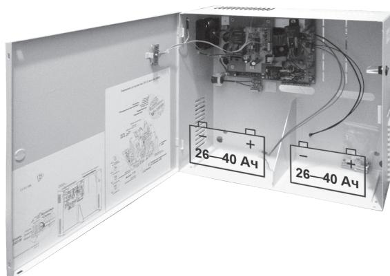
**12 В, 18 А, регулируемый ток заряда АКБ, термокомпенсация тока заряда АКБ. Корпус под 2 АКБ 40 Ач. 5 информационных выходов о состоянии источника. Электронная защита от перегрева, КЗ выхода и АКБ. Кнопка отключения нагрузки. Диапазон входного напряжения 170–250 В.**
