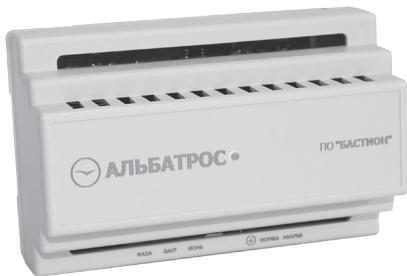
Защитное устройство АЛЬБАТРОС-1500 DIN предназначено для защиты потребителей электрической сети 220 В, 50 Гц с потребляемой мощностью до 1,5 кВт от кратковременных и длительных перенапряжений до 500 В переменного тока промышленной частоты 50 Гц.
