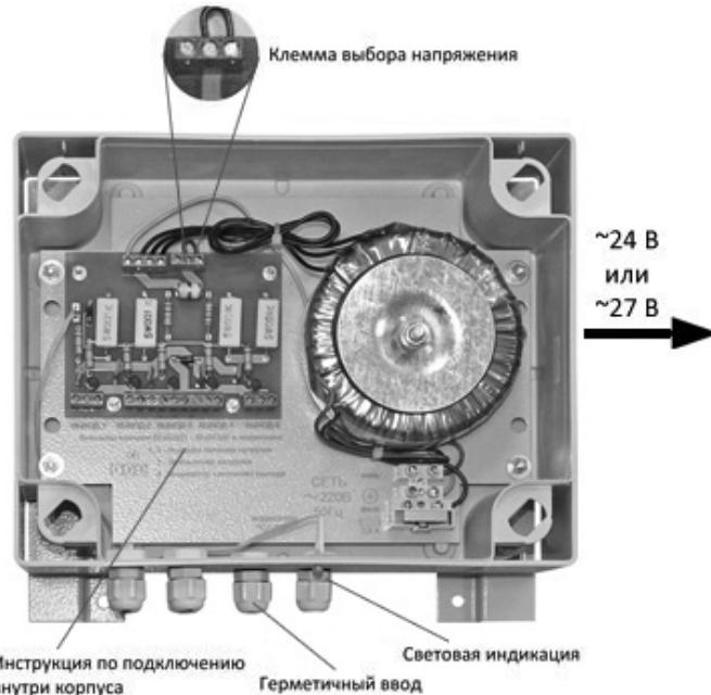
*Сетевой (не бесперебойный) источник питания. Выходное переменное напряжение 24 В или 27 В, 50 Гц. 5 выходов, ток каждого выхода 1 А. Выход 27 В используется для компенсации падения напряжения на длинной линии. Защита выходов от КЗ PolySwitch, световая индикация по каждому каналу. Возможность объединения каналов до 5 А. Уличное исполнение, класс защиты IP56. Рабочий температурный диапазон от -40 °C до +50 °C.*
