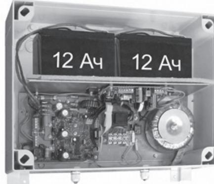
2 выхода переменного напряжения 220 В и 24 В суммарно 150 ВА. Корпус под 2 термостата АКБ 12 Ач, дистанционное сообщение о переходе на резерв и о разряде АКБ, защита АКБ, защита нагрузки. Уличное исполнение IP56, рабочий температурный диапазон от -40 °C до +50 °C.
