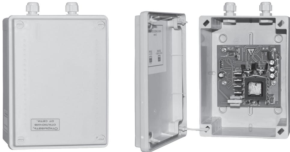
Преобразователь напряжения с входного 12–15 В в выходное 220 В. Мощность 30 ВА. Уличное исполнение. Класс защиты IP56, рабочий температурный диапазон от -40 °C до +50 °C.
