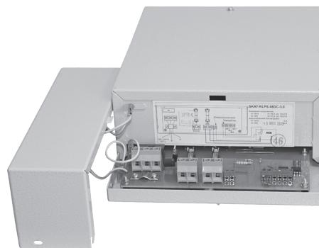
**48 В, 3 А, и до 10 А при наличии АКБ (АКБ в буфере). Длительный режим резерва. Используется с внешними АКБ 17–250 Ач (4 шт.). Световая индикация и информационные выходы контроля технического состояния блока. Каскадное наращивание мощности. Настольное исполнение, возможность монтажа в стойку 19".**
