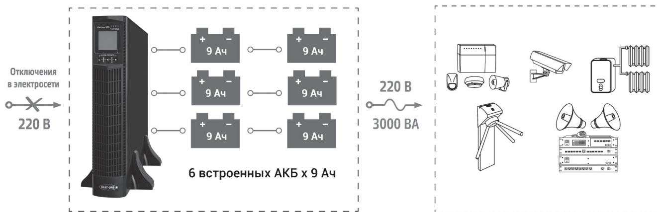
Изделие представляет собой современный экономичный источник бесперебойного питания с функциями защиты и контроля и обеспечивает подключенные к его выходу устройства длительным, стабилизированным электропитанием при отсутствии напряжения сети, используя при этом электроэнергию, запасенную в аккумуляторных батареях
