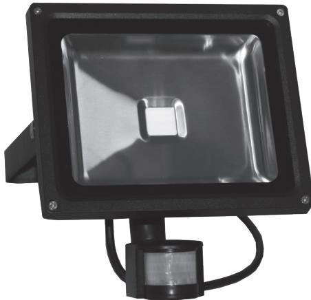
*Прожектор светодиодный уличный с датчиком движения. Напряжение 220 В, Мощность 30 Вт. Степень защиты IP54. 1 светодиод. Цветовая температура 2700–7500 К. Размеры 225 x 256 x 130 мм.*
