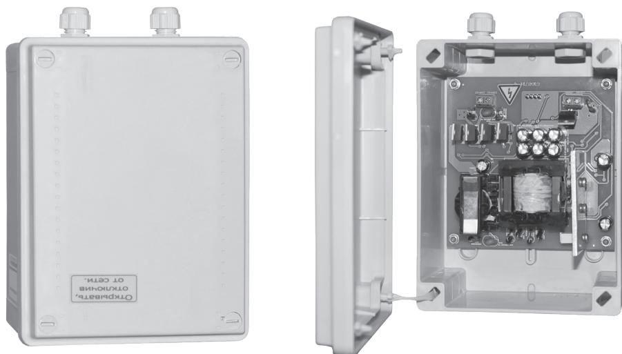
Преобразователь напряжения с входного 12–15 В в выходное 220 В. Мощность 60 ВА. Уличное исполнение. Класс защиты IP56, рабочий температурный диапазон -40 °C до +50 °C.
