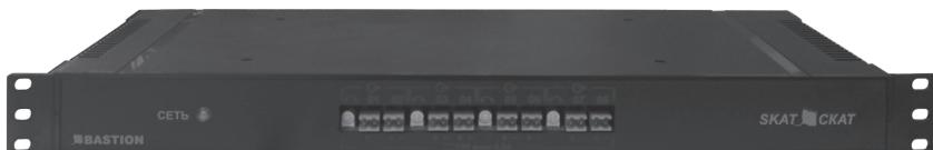
19", 1U, 8 выходов по 0,5 А, 12 В или 4 выхода по 1 А. Плавная регулировка выходного напряжения от 12 до 15 В, максимальный ток по всем выходам 4 А. Электронная защита выходов по току и от КЗ, фильтрация помех для устранения взаимного влияния нагрузок. Не бесперебойный.
