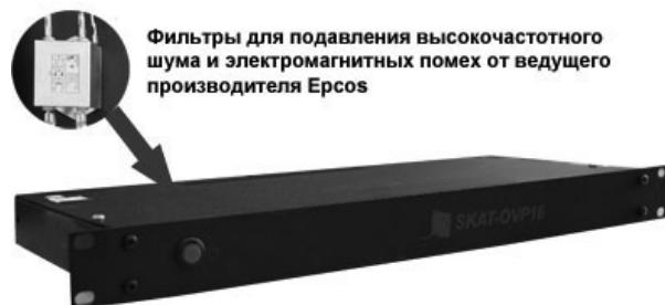
**Сетевой фильтр 19", 1U, 6 выходов/3 канала, максимальная нагрузка 16 А (3,5 кВА). Защита от импульсных перенапряжений до 6000 В, защита нагрузок от проникновения ВЧ помех и взаимного влияния по сети 220 В, защита сети 220 В от проникновения ВЧ помех от нагрузок. Для систем речевого оповещения, телекоммуникационного оборудования, комплексов CCTV.**
