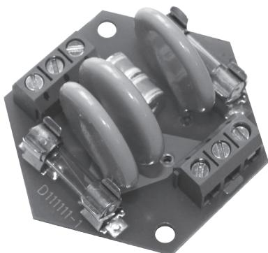
*Устройство защиты от импульсных перенапряжений (УЗИП). Защищает по сети по 220 В, 500 ВА, защита от перенапряжения по «фазе», «нулю» и «земле». Отсутствуют ложные срабатывания на индуктивную нагрузку.*
