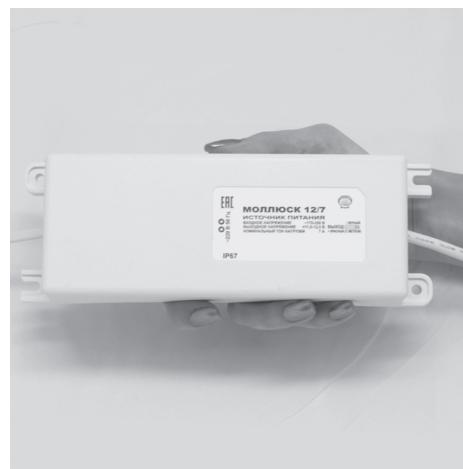
12 В, 7 А, габариты 205 x 70 x 40 мм, защищена выходом от КЗ и перегрузки, прочность изоляции 3 кВ, проушины для крепления, корпус IP67.
