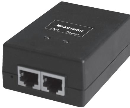
Одноканальный High PoE инжектор PSE-PoE.220AC/28VA предназначен для питания по сети Gigabit Ethernet IP-камер или другого оборудования, поддерживающего стандарты технологии PoE IEEE 802.3af, IEEE 802.3at. Автоматическое определение PoE устройств. Питание: AC100-240 В. Мощность PoE – 28 Вт. Сетевой шнур 220 В в комплекте.
