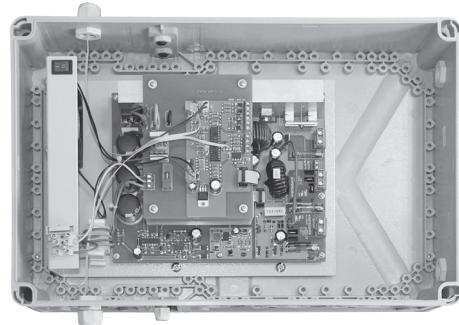
**24 В, 18 А, уличное исполнение, класс защиты IP56, вандалоустойчивый пластиковый корпус, регулируемый ток заряда АКБ, термокомпенсация тока заряда АКБ. АКБ – внешние 2 шт. от 26 до 200 Ач, 5 информационных выходов о состоянии источника. Электронная защита от перегрева, КЗ выхода и АКБ. Кнопка отключения нагрузки. Диапазон входного напряжения 170–250 В. Рабочий температурный диапазон от -40 °C до +50 °C.**
