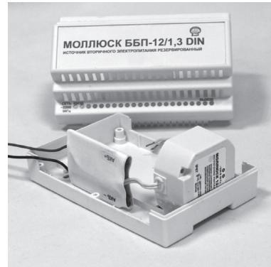
14 В, 1,3 А. Бюджетный ИБП в корпусе на DIN-рейку. Место для встроенной АКБ на 1,2 Ач. Расширенный сетевой диапазон 90–250 В. Защита выхода от КЗ и перегрузки, прочность изоляции 3 кВ.
