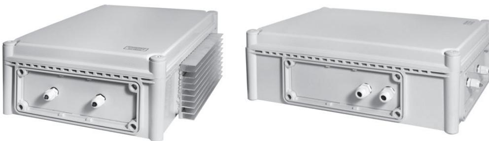
*ИБП для стационарных радиостанций 13,8 В, ток до 19 А, при соотношении передача/прием 1:4, пластиковый корпус уличного исполнения (класс защиты IP56) под АКБ 12–17 Ач. При температурах до -40 °C использовать в комплекте с АО 1/40 исп.5 и термостатами 12/7, 12/12, 12/26 или 12/40.*
