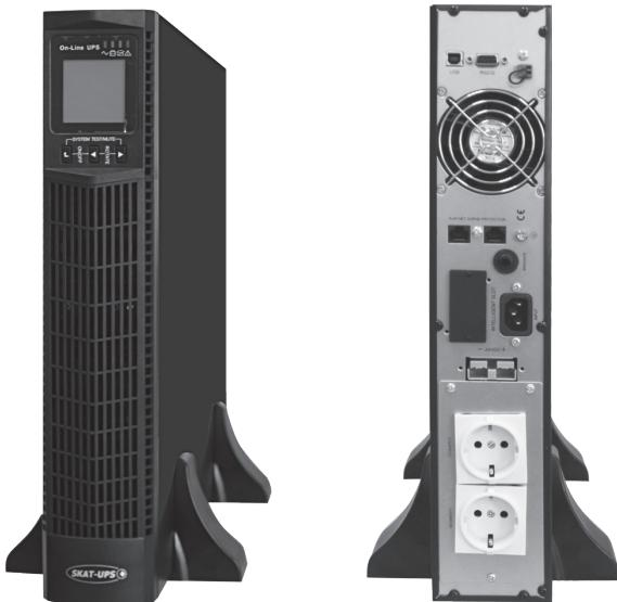
**220 В, 1000 ВА (900 Вт) On-Line, синусоидальная форма выходного напряжения, световая и звуковая индикация режимов работы, ЖК-дисплей, необходимое количество АКБ для работы – 2 шт. (24 В). минимальная требуемая ёмкость 17 Ач. Ток заряда АКБ – 6 А. Дистанционный мониторинг по RS 232, USB, порт для платы релейного интерфейса. Возможность подключения SNMP-модуля DL-801. Функция удаленного аварийного отключения выходного напряжения (EPO). Корпус под 19» шкаф, высота 2U или настольная установка.**
