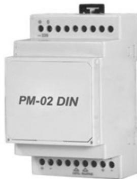
2-х канальный релейный модуль для управления нагрузкой 220 В, 8 А. Управляющий сигнал 12 В. Предназначен для использования в системах дежурного освещения, пожарной и охранной сигнализации, а также иных коммутируемых системах с управлением нагрузкой по двум каналам. Входит в состав интеллектуальной системы освещения. Крепление на DIN рейку.
