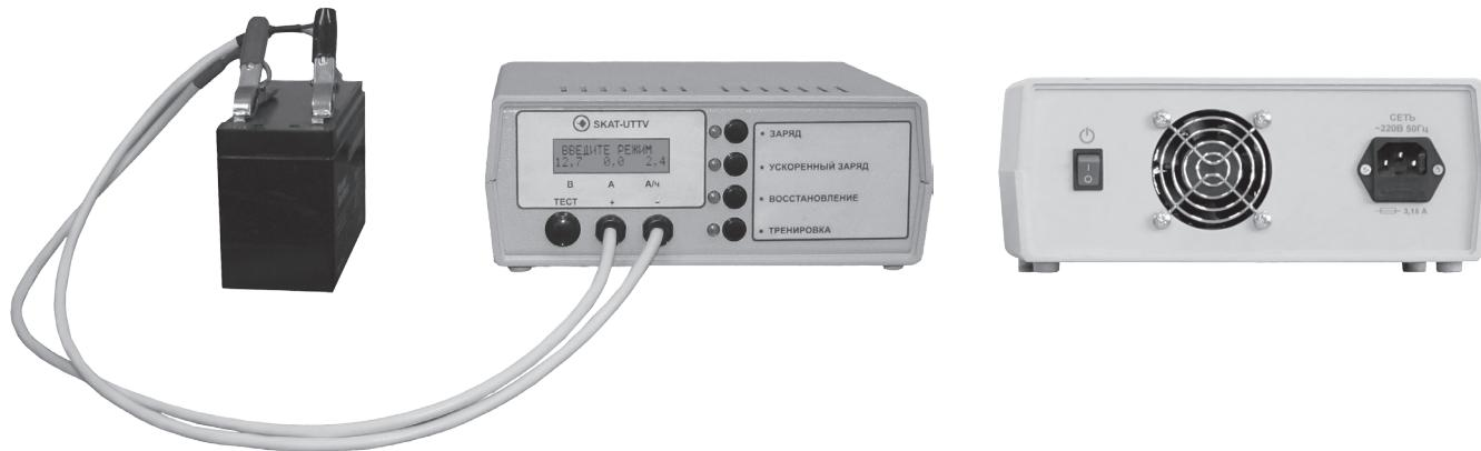
*Полностью автоматическое устройство тестирования, тренировки, восстановления и заряда свинцово-кислотных АКБ – герметичных и открытого типа (автомобильные). Заряд АКБ с током заряда 1/20 от остаточной емкости. Ускоренный заряд АКБ с током заряда 1/6 от остаточной емкости. Восстановление АКБ, имеющих сульфатацию пластин. Тренировка АКБ с помощью циклов разряда/заряда. Цифровой дисплей. Работает с АКБ до 120 Ач.*
