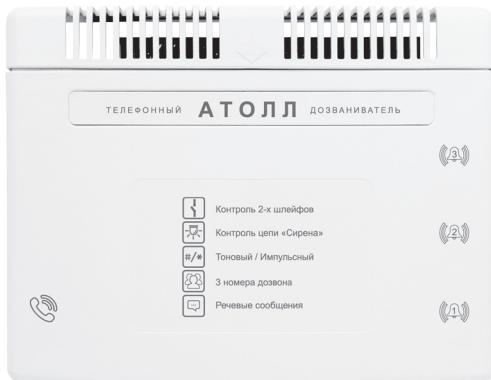
*Телефонный дозваниватель по телефонной линии, 2 независимых сигнальных входа, вход типа «Сирена». Энергонезависимая память. Дозвон по 3 номерам, набор номера в импульсном или тоновом режиме, длина номера 15 знаков, включая паузу и «8». Перезапись речевых сообщений для каждой сигнальной цепи, встроенный динамик. Питание 12 В.*
