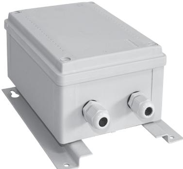
*Защитное устройство АЛЬБАТРОС-1500 исп.5 предназначено для защиты потребителей электрической сети 220 В, 50 Гц с потребляемой мощностью до 1,5 кВт от кратковременных и длительных перенапряжений до 500 В переменного тока промышленной частоты 50 Гц. Уличное исполнение, IP56.*
