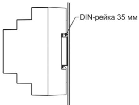
**Защитно-коммутационное устройство для коммутации и защиты от КЗ линии питания 9–28 В, 8 каналов по 1 А; бысторазъемные клеммы для удобства монтажа; самовосстанавливающиеся предохранители в каждом канале, индикация по каждому каналу. Малогабаритный корпус на DIN-рейку.**
