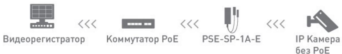
*Одноканальный сплиттер. Позволяет подключать IP-видеокамеры без поддержки PoE к коммутаторам с PoE. Сплиттер разделяет сигнал с витой пары RJ-45 (данные+питание) на отдельный канал данных RJ-45 и отдельный канал питания 12 В. Скорость соединения 10/100 Mbps. Диапазон входного напряжения 37–57 В, выходная мощность 13 Вт. Поддержка Auto-MDI/MDI-X. Защита от перегрева, перенапряжения, защита от короткого замыкания и перегрузки.*
