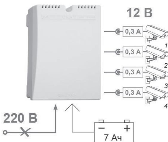
**4 выхода 12 В на видеокамеры; плавная регулировка выхода 12–15 В, ток каждого выхода – 0,35 А.**
