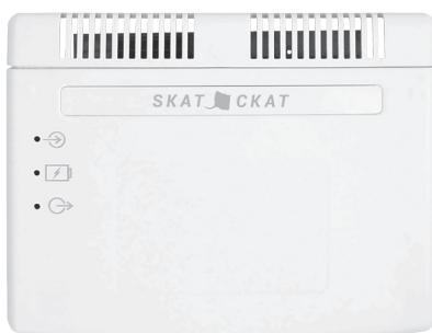
*Малогабаритный ИБП со встроенной Li-ion АКБ. Внешний блок питания. Стабилизированное выходное напряжение 12 В. Выходной ток 1 А. Время работы от АКБ на максимальной нагрузке 2 часа. Защита АКБ от разряда. Защита АКБ от КЗ в нагрузке. Электронная защита выхода от КЗ. Выключатель АКБ. Переходник 5,5x2,5 в комплекте. Холодный пуск. Собственное потребление менее 40 мА. Внутренняя Li-ion АКБ 5200 мАч, 7,4 В (в комплекте). Корпус под DIN рейку 35 мм, Размер – 150 x 120 x 45 мм. Гарантия 5 лет.*
