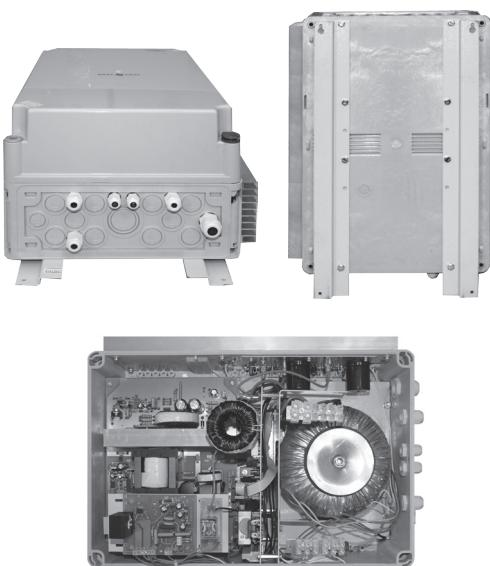
**220 В, 800 ВА, (600 Вт), Off-Line, синусоидальная форма выходного напряжения. Необходимое кол-во АКБ для работы – 4 шт. (внешние). Информационный сигнал о пропадании сети (реле). Электронная защита выхода от КЗ и перегрузки, защита АКБ от глубокого разряда, защита от перенапряжения на входе (автоматическая). Уличное исполнение, класс защиты IP 56, корпус Hensel, Германия, рабочий температурный диапазон от -40 °C до + 50 °C.**
