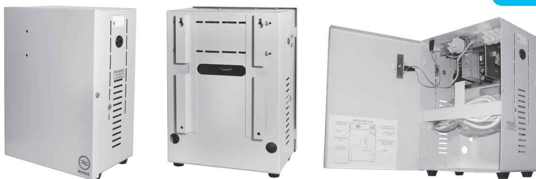
ИБП для стационарных радиостанций 13,8 В, ток до 30 А, при соотношении передача/прием 1:2, корпус под АКБ 26 Ач. Выходной ток 30 А в режиме передачи, используя энергию АКБ. Заряд АКБ током 5 А. Возможность работы как со встроенной АКБ (26 Ач), так и с внешней (до 200 Ач). Автоматическая подзарядка и защита аккумулятора от глубокого разряда. Защита от перегрева с автоматическим переходом в резервный режим. Защита от переполюсовки аккумулятора.
