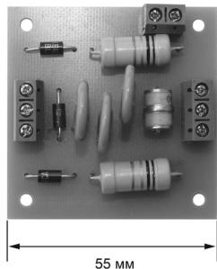
*Блок защиты от скачков напряжения в цепях постоянного напряжения 24 В, 70 Вт.*
