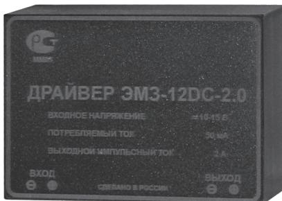
Драйвер ЭМЗ-12DC-2.0 предназначен для совместной работы с электромеханическим замком и позволяет использовать маломощный источник питания напряжением 10–15 В с допустимым током нагрузки не ниже 50 мА для открытия электромеханического замка, а так же позволяет открыть его однократно при отсутствии питания до 2 часов.
