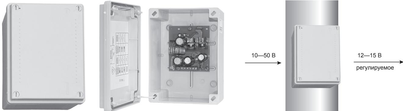
Преобразователь напряжения с входного 10–60 В стабилизированное выходное напряжение 12 В, 1,5 А. Диапазон регулировки выходного напряжения 12–15 В. Уличное исполнение, класс защиты IP 56. Рабочий температурный диапазон от -40 °C до +40 °C.
