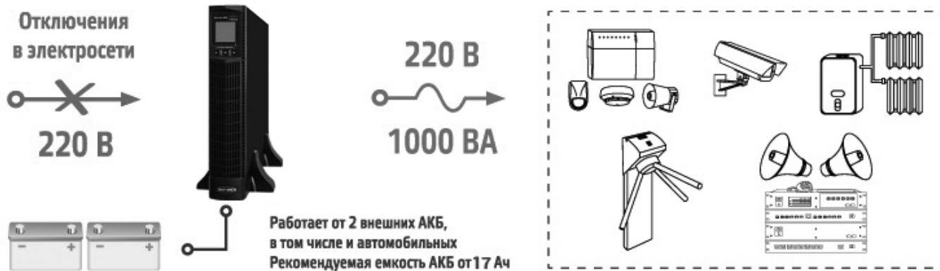
Изделие представляет собой современный экономичный источник бесперебойного питания с функциями защиты и контроля и обеспечивает подключенные к его выходу устройства длительным, стабилизированным электропитанием при отсутствии напряжения сети, используя при этом электроэнергию, запасенную в аккумуляторных батареях.
