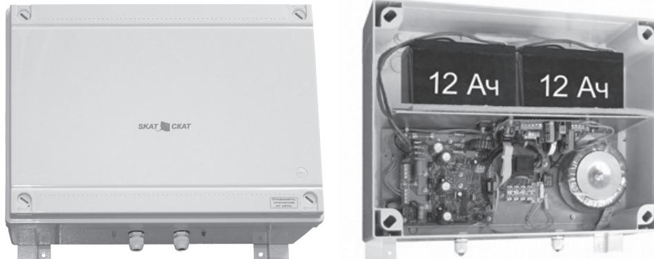
2 выхода переменного напряжения 220 В и 24 В суммарно 150 ВА. Корпус под 2 термостата АКБ 12 Ач, дистанционное сообщение о переходе на резерв и о разряде АКБ, защита АКБ, защита нагрузки. Уличное исполнение IP56, рабочий температурный диапазон от -40 °C до +50 °C.
