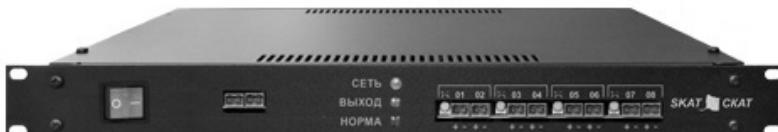
19", 1U, 8 выходов по 0,5 А или 4 выхода по 1 А. Плавная регулировка выходного напряжения, максимальный ток по всем выходам – 4,5 А, 2 внешние АКБ 26 Ач. 2 информационных выхода о состоянии источника.
