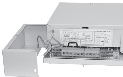
**12 В, 12 А, и до 20 А при наличии АКБ.** Автоматика подогрева, регулируемый ток и напряжение заряда внешней АКБ емкостью 17–250 Ач. Световая индикация и информационные выходы контроля технического состояния блока. Возможность использования в режимах зарядного устройства АКБ и источника резервного питания
