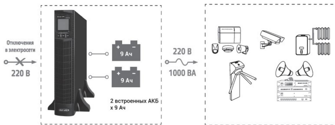
Изделение представляет собой современный экономичный источник бесперебойного питания с функциями защиты и контроля и обеспечивает подключенные к его выходу устройства длительным, стабилизированным электропитанием при отсутствии напряжения сети, используя при этом электроэнергию, запасенную в аккумуляторных батареях.
