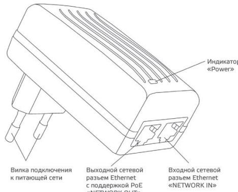
Одноканальный инжектор предназначен для питания по сети Fast Ethernet 10/100 Base-T IP-видеокамер или другого оборудования, поддерживающего стандарты технологии PoE IEEE 802.3af. Питание: AC 100–250 В. Мощность – 15,4 Вт. Не требует монтажа, устанавливается в сетевую розетку.
