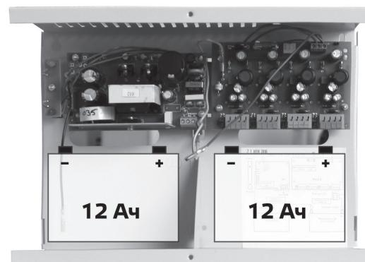
**8 выходов по 0,5 А или 4 выхода по 1 А, корпус под 2 АКБ 12 Ач. Суммарный ток по выходам 3 А.**
