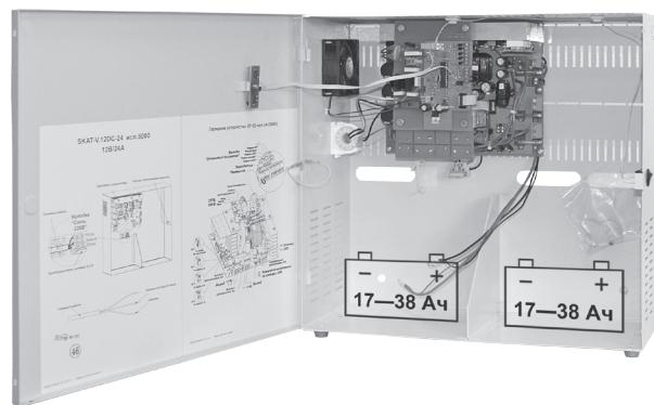
**24 В, 18 А**, регулируемый ток заряда АКБ, термокомпенсация тока заряда АКБ. Корпус под 2 АКБ 40 Ач. 5 информационных выходов о состоянии источника. Электронная защита от перегрева, КЗ выхода и АКБ. Кнопка отключения нагрузки. Диапазон входного напряжения 170–250 В.
