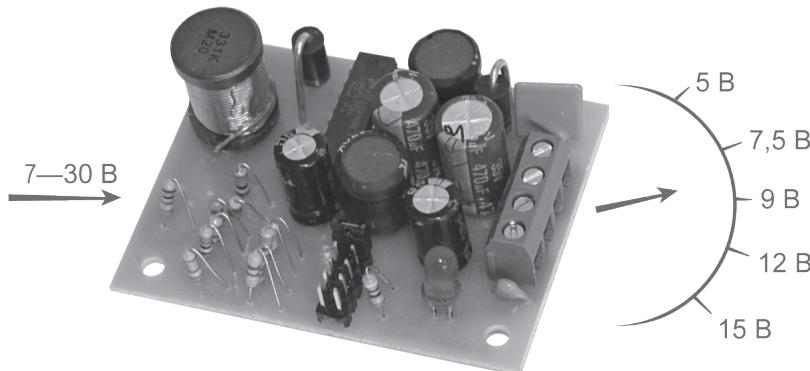
Универсальный преобразователь напряжения входного напряжения от 7 до 30 В в фиксированное выходное напряжение 5 | 7,5 | 9 | 12 | 15 В, максимальный ток 1,5 А. Преобразователь представляет собой встраиваемый модуль на печатной плате размером 49x64 мм. На плате расположены входная и выходная соединительные колодки, индикатор выхода, переключатель выходного напряжения (см. рисунок).
