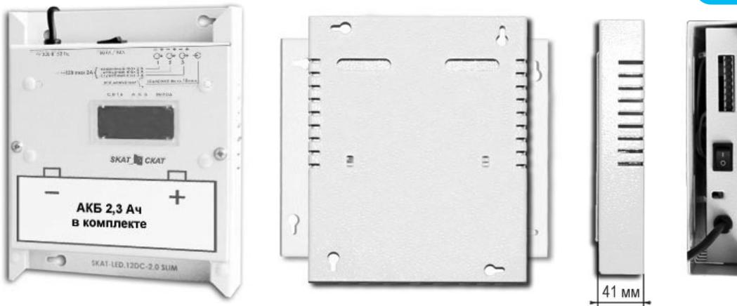
Источник бесперебойного питания с функцией управления светодиодными светильниками. З выхода 12 В до 2 А. Управляющий вход. Режимы работы «Аварийный», «Дежурный» и «Дежурный управляемый». Питание внешних датчиков. АКБ 2,3 Ач в комплекте. Индикация состояния источника и АКБ. Настенная/настольная/потолочная установка, ультратонкий корпус (42 мм). Габариты 220 x 182 x 42 мм.
