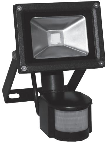
*Прожектор светодиодный уличный с датчиком движения. Напряжение 220 В, Мощность 10 Вт. Степень защиты IP 54. 1 светодиод. Цветовая температура 2700–7500 К. Размеры 115 x 155 x 85 мм.*
