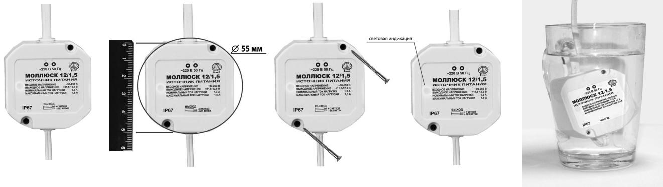
**12 В, 1,5 А.** Расширенный сетевой диапазон 90–250 В, габариты 50x50x25 мм, скругленные края Ø 55 мм, защита выхода от КЗ и перегрузки, прочность изоляции 3 кВ, отверстия для крепления, корпус IP-67. Обновление модели: Белый корпус, светодиодная индикация.
