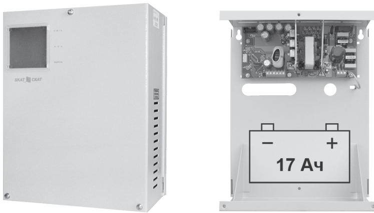
**12 В, 6,5 А.** Корпус под АКБ 17 Ач, диапазон входного напряжения 170–242 В.**Соответствует ФЗ 123 и ГОСТ Р 53325-2012:** 3 индикатора и 3 информационных выхода – Сеть, АКБ, Выход, защита выхода от перегрузки и КЗ, защита АКБ от глубокого разряда, КЗ и переполюсовки, контроль наличия АКБ, холодный пуск.
