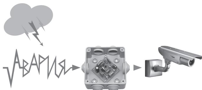
«АЛЬБАТРОС-12/70» предназначен для защиты от кратковременного или длительного перенапряжения, вызванного наводками в результате воздействия электромагнитных импульсов (грозовые разряды, коммутационные помехи и др.) и авариями в цепи электропитания приборов. Блок рассчитан на использование в цепях питания номинальным напряжением 12 В постоянного тока. Обеспечивает защиту от высоковольтных импульсов амплитудой до 10 кВ.
