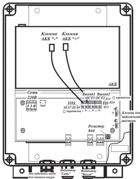
**12 В, 2 А.** Регулируемый выход 5–9 В, 25 ВА (ступенчатая и плавная регулировка), регулируемый ток заряда АКБ, подогрев АКБ (термостат АКБ не нужен), уличное исполнение, корпус класса защиты IP56, рабочий температурный диапазон от -40 °C до +50 °C, диапазон входного напряжения 170–250 В. Корпус под АКБ 7 Ач.
