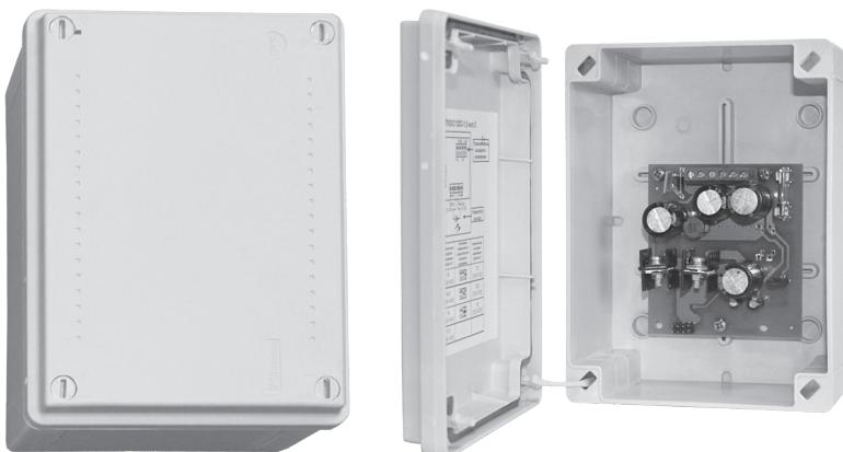
Преобразователь напряжения с входного 20–75 В в стабилизированное выходное напряжение 12 В, 1,5 А постоянного тока. Регулировка выходного напряжения 12–15 В. Фильтрация ВЧ помех, защита выхода от перегрузки и КЗ. Уличное исполнение IP56, рабочий температурный диапазон от -40 °C до +40 °C.
