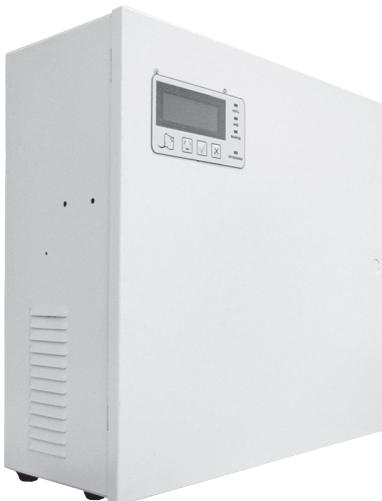
**12 В, 12 А**, модуль визуализации, корректор мощности, диапазон сети 85–260 В, термокомпенсация заряда АКБ, защита от КЗ в нагрузке, защита устройства и нагрузки от неправильного подключения АКБ, защита от КЗ клемм АКБ, контроль наличия АКБ, защита АКБ от глубокого разряда. 5 информационных выходов (реле). Вычисление реальной остаточной емкости АКБ. Возможность двойного резервирования АКБ. Холодный запуск.
