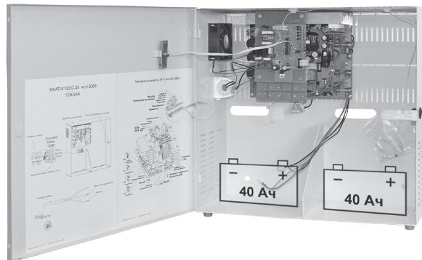
**12 В, 24 А**, регулируемый ток заряда АКБ, термокомпенсация тока заряда АКБ. Корпус под 2 АКБ 40 Ач. 5 информационных выходов о состоянии источника. Электронная защита от перегрева, КЗ выхода и АКБ. Кнопка отключения нагрузки. Диапазон входного напряжения 170–250 В.
