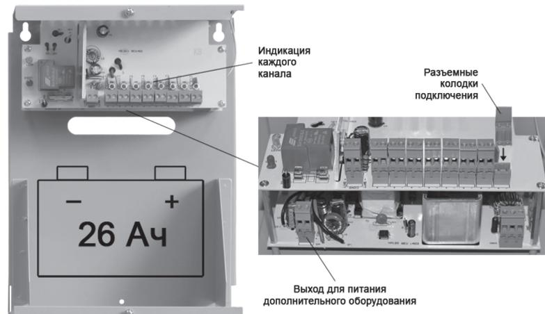
**12 В, 10 А, 8 выходов 12В по 0,5–1 А, Дополнительный выход (клеммы) для питания видеорегистраторов и другой аппаратуры до 4 А, защита от КЗ и перегрузки по каждому каналу, самовосстановляющиеся предохранители в каждом канале, внутренняя индикация состояния каждого канала, корпус под 26 Ач, защита АКБ от глубокого разряда, КЗ и переполюсовки. Разъемные колодки подключения.**
