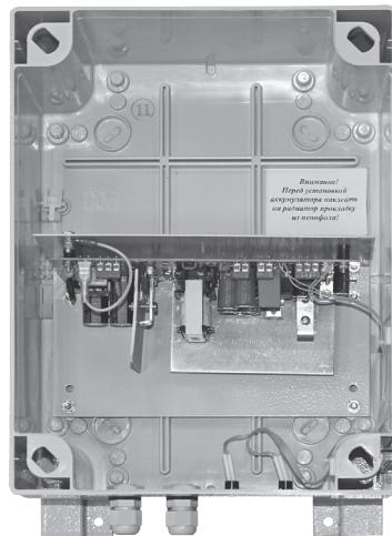
**12 В, 4 А** (без учета тока на подогрев АКБ), уличное исполнение, корпус класса защиты IP56, рабочий температурный диапазон от -40 °C до +50 °C, диапазон входного напряжения 170–250 В. Корпус под термостат 7 или 12 Ач.
