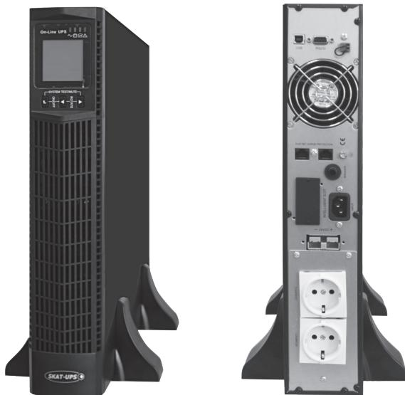
**220 В, 3000 ВА (2700 Вт) On-Line, синусоидальная форма выходного напряжения, световая и звуковая индикация режимов работы, ЖК дисплей. Встроенные АКБ 9 Ач, 6 шт, время резерва 3 мин. Возможность подключения внешних АКБ. Дистанционный мониторинг по RS 232, USB, порт для платы релейного интерфейса. Возможность подключения SNMP-модуля DL 801. Функция удаленного аварийного отключения выходного напряжения (EPO). Корпус под 19» шкаф, высота 2U или настольная установка.**
