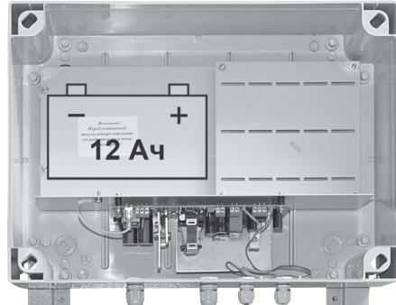
**12 В, 4 А** (без учета тока на подогрев АКБ), уличное исполнение, класс защиты IP56, рабочий температурный диапазон от -40 °C до +50 °C, диапазон входного напряжения 170–250 В. Корпус под термостат 7 или 12 Ач.
