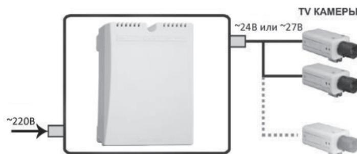
Сетевой (не бесперебойный) источник питания. Выходное переменное напряжение 24 В или 27 В, 50 Гц. Максимальный ток выхода – 5 А. Выход 27 В используется для компенсации падения напряжения на длинной линии.
