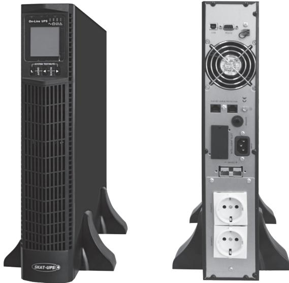
**220 В, 3000 ВА (2700 Вт)** On-Line синусоидальная форма выходного напряжения, световая и звуковая индикация режимов работы, необходимое количество АКБ для работы – 6 шт. (72 В), минимальная требуемая ёмкость 17 Ач. Ток заряда АКБ – 6 А. Дистанционный мониторинг по RS 232, USB, порт для платы релейного интерфейса. Возможность подключения SNMP-модуля DL-801. Функция удаленного аварийного отключения выходного напряжения (EPO). Корпус под 19" шкаф, высота 2U или настольная установка.
