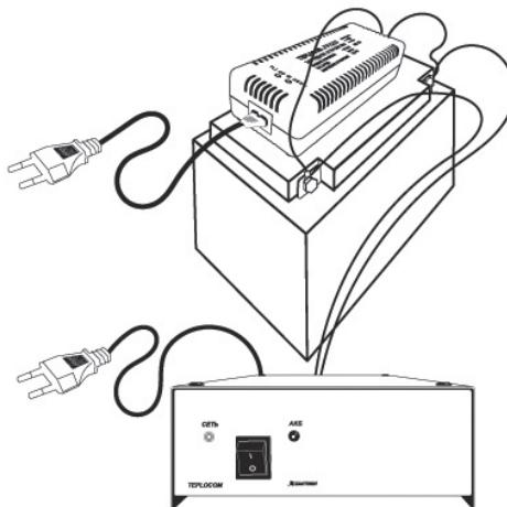
Дополнительное зарядное устройство для ИБП TEPLOCOM-300. Предназначено для ускорения зарядки свинцово-кислотных АКБ, подключаемых к TEPLOCOM-300. Зарядный ток – 3 А. Оптимальный заряд, защита от короткого замыкания и переполюсовки, защита от разряда АКБ.
