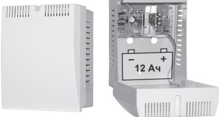
**12 В, 3 А, металлопластиковый корпус под АКБ 7–12 Ач, диапазон входного напряжения 170–250 В. Соответствует ФЗ 123 и ГОСТ Р 53325-2012:**
