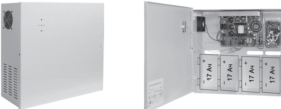
**48 В, 9 А и 36 В, 6 А. 2 выхода.** Для построения систем питания удаленных объектов совместно с преобразователями напряжения. Нагрузка перераспределяемая по выходам. Защита выходов от перенапряжения, защита АКБ, релейные выходы о состоянии сети и АКБ, АКБ – до 17 Ач (4 шт.).
