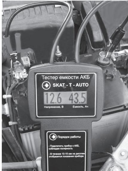
**АВТОматический тестер контроля емкости АКБ 12 В, ёмкостью от 1,2 до 120 Ач. Оценка и цифровая индикация фактической емкости АКБ. Быстрая оценка емкости АКБ (около 15 сек), не требует калибровки или выбора диапазона измерений, цифровой дисплей.**
