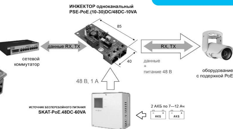
*Инжектор одноканальный. Максимальная мощность нагрузки инжектора составляет: при питании от ИБП 12 В – 5 Вт, 24 В – 10 Вт и 48 В – 20 Вт. Инжектор обеспечивает защиту каналов передачи и приёма данных от импульсных помех, а также защиту от импульсных перенапряжений.*
