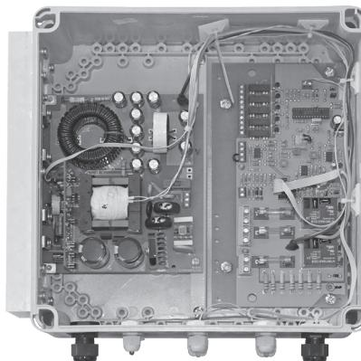
**12 В, 18 А, уличное исполнение, класс защиты IP56, вандалоустойчивый пластиковый корпус, регулируемый ток заряда АКБ, термокомпенсация тока заряда АКБ. АКБ – внешняя 1 шт. от 26 до 200 Ач, 5 информационных выходов о состоянии источника. Электронная защита от перегрева, КЗ выхода и АКБ. Кнопка отключения нагрузки. Диапазон входного напряжения 170–250 В. Рабочий температурный диапазон от -40 °C до +40 °C.**
