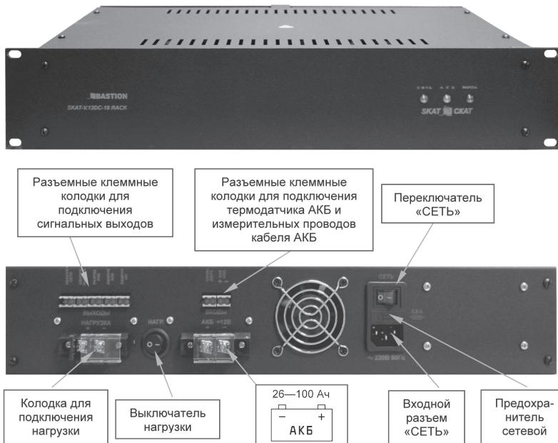
**12 В, 18 А, регулируемый ток заряда АКБ, термокомпенсация тока заряда АКБ.** Корпус для установки в 19" шкаф, высота 2U, 5 информационных выходов о состоянии источника в формате «сухие контакты реле». Электронная защита от перегрева, КЗ выхода и АКБ. Кнопка отключения нагрузки. Диапазон входного напряжения 170–250 В
