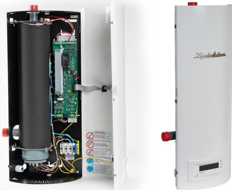
220/380 В, группа ТЭН по ГОСТ 13268-88. Микропроцессорное управление, симисторные ключи, расширенная цифровая, светодиодная и звуковая индикация, модуляция мощности, плавный пуск с предварительным подогревом, интеллектуальный алгоритм продления срока службы, дежурная подсветка. Вход для внешнего термостата и погодозависимой автоматики. Размер ВхШхГ — 710х323х172. Присоединительный размер 1".
