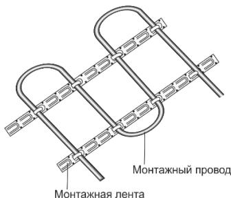
Рисунок 4 – Прокладка нагревательной секции через монтажную ленту.
