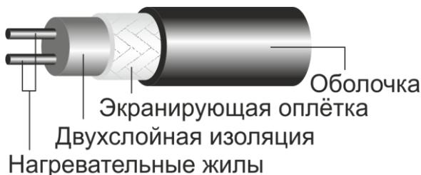
Рисунок 3 – Устройство нагревательного провода.
