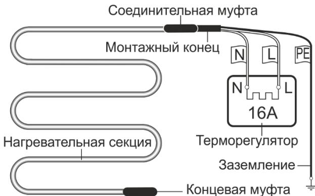
Рисунок 6 – Подключение теплого пола к терморегулятору.
