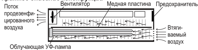
Рисунок 1 — Принцип работы рециркулятора
