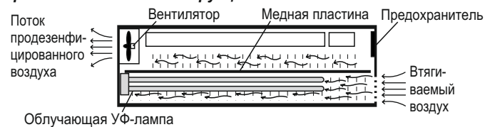
Рисунок 1 — Принцип работы рециркулятора
