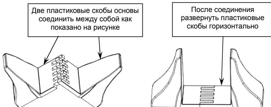
Рисунок 3 - Сборка пластиковых основ для вертикальной установки изделия.
