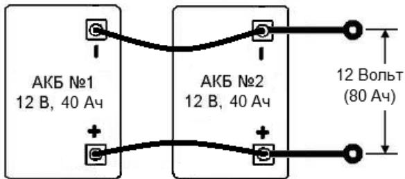
Для увеличения ёмкости АКБ подключают параллельно.
