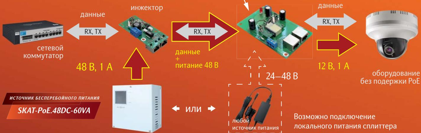
Максимальная длина сегмента в сети 100Base-T составляет 100 м. Репитер PoE позволяет увеличить длину линии до оконечных сетевых устройств путём последовательного соединения сегментов.
