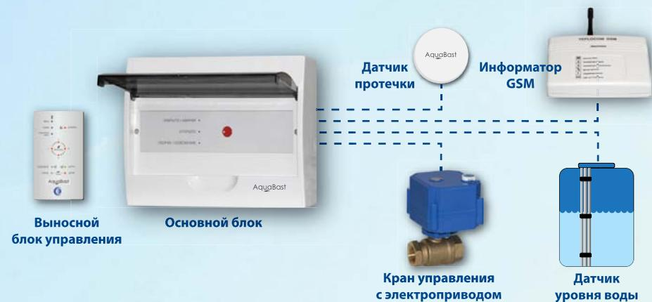
Система AquaBast состоит из модуля управления и подключенных к нему в зависимости от конфигурации датчиков протечки, кранов с электроприводом, информатора GSM и датчика уровня воды.
