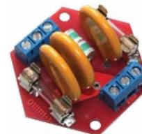
АЛЬБАТРОС-220/500 АС предназначен для защиты нагрузки от кратковременных аварийных перенапряжений, вызванных воздействием электромагнитных импульсов (грозовые разряды, коммутационные помехи и др.) и авариями в сети с номинальным напряжением 220В.
