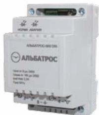
Защитное устройство АЛЬБАТРОС-500 DIN предназначено для защиты потребителей электрической сети 220 В, 50 Гц с потребляемой мощностью до 0,5 кВт от кратковременных и длительных перенапряжений до 500 В переменного тока промышленной частоты 50 Гц. Блок рассчитан на круглосуточный режим работы в закрытых помещениях. Условия эксплуатации согласно техническим характеристикам, указанным в таблице, при отсутствии в воздухе агрессивных веществ (паров кислот, щелочей и пр.) и токопроводящей пыли.
