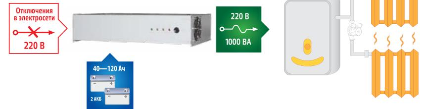
Источник бесперебойного питания ТЕРЛОСОМ-1000 предназначен для непрерывного электроснабжения многоконтурных систем индивидуального отопления с автозапуском, оснащенных циркуляционными электронасосами.
