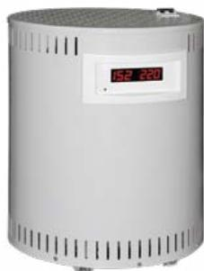
Стабилизатор напряжения SKAT ST-12345 — это 12 кВА мощности в широком диапазоне входного напряжения и «чистый синус» выходного напряжения. Это — быстрое управление стабилизацией, переключение обмоток трансформатора в момент перехода фазы через ноль, мощные симисторные ключи. Уникальный корпус, обеспечивает эффективное бесшумное охлаждение и компактные размеры. SKAT ST-12345 — это высокая надежность устройства, соответствие российским и международным стандартам, длительная заводская гарантия.
