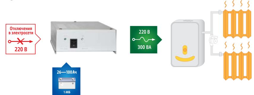
Источник бесперебойного питания ТЕРЛОСОМ-300 предназначен для непрерывного электроснабжения котлов индивидуального отопления с автозапуском, оснащенных циркуляционными насосами.
