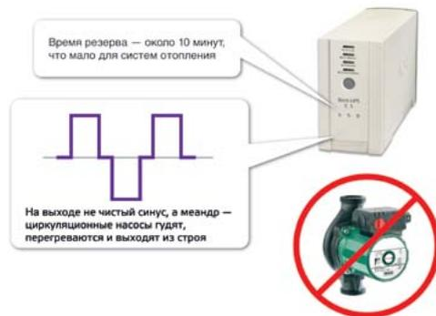
Обычный компьютерный UPS, работающий от АКБ 7-12 Ач никогда не обеспечит многочасовое время резервирования тепловой системы (в то время, как наши источники способны заряжать аккумуляторы до 200 Ач и более!), к тому же его использование затруднено из-за известных проблем фазировки, когда розжиг котла просто не включается.
