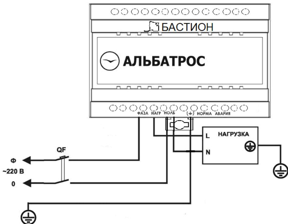
Рисунок 4 – схема подключения изделия и нагрузки 1-го класса
