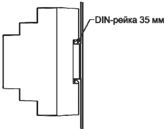
Рисунок 2 – установка блока
