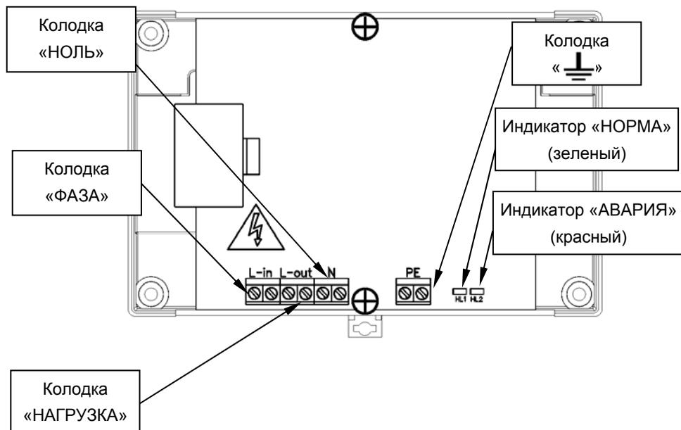
Рисунок 1 - общий вид изделия со снятой крышкой
