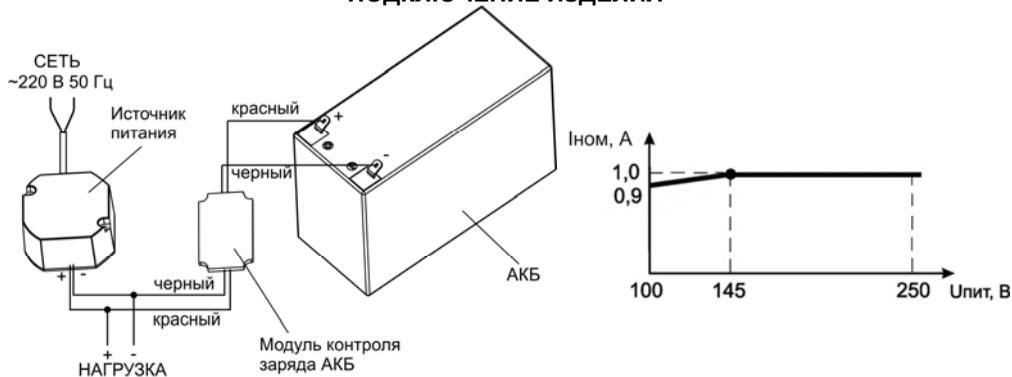
Рисунок 1 — схема подключения и состав изделия
