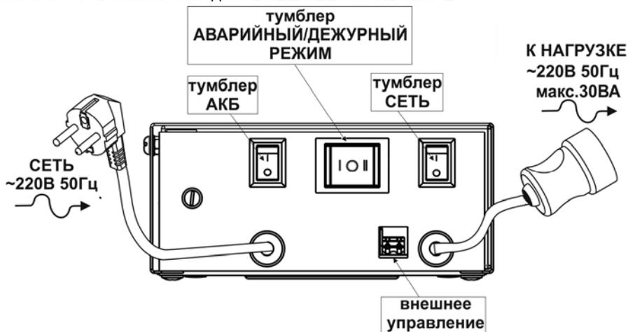
Рисунок 2 - вид изделия со стороны подключения
