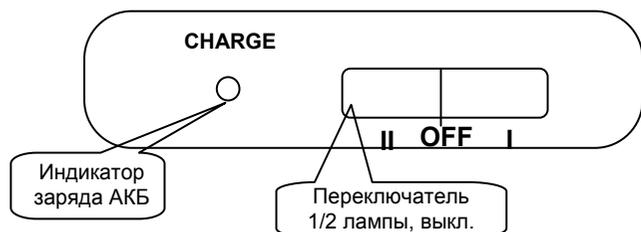
Светильник обеспечивает автоматический выбор одного из двух режимов работы с соответствующей индикацией:
