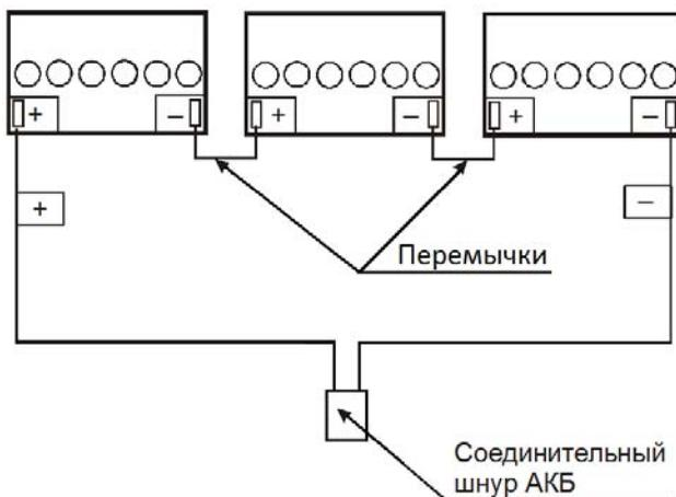
Рисунок 2. Схема соединения аккумуляторов в батарею.
