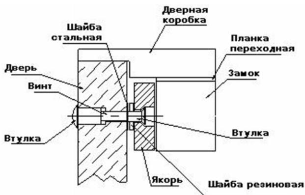
Сначала устанавливается накладка (крепежная планка, - при поставке она идёт в сборе с замком), подводятся и подсоединяются провода, крепится сам замок. Потом на двери, напротив замка устанавливается якорь. Крепление якоря рассчитано таким образом, чтобы удерживать дверь под нагрузкой, на которую рассчитан электромагнитный замок.
