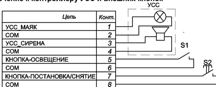
Рисунок 8 Схема подключения внешних устройств
