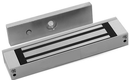
Электромагнитные замки являются дистанционно-управляемыми запорными устройствами и могут использоваться в качестве «устройств исполнительных» по классификации ГОСТ Р 51241-2008 в системах контроля и управления доступом. Дверь закрывается и открывается благодаря наличию внутри изделия электромагнита. Управлять таким запорным устройством можно при помощи
